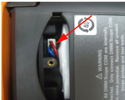
図8-6 ピンセットを使って3端子コネクタを引き抜く
