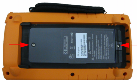
図8-3 バッテリー・カバーのネジを外す
