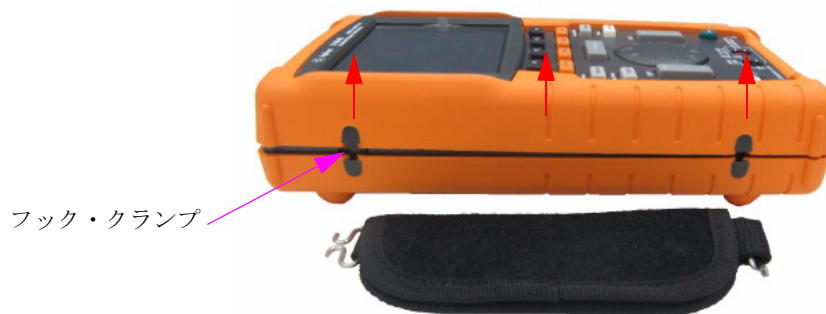
図8-8 ハンドラを測定器から取り外す
