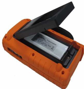
図8-5 スタンドを取り外さずにバッテリー・パック・カバーを取り外す
